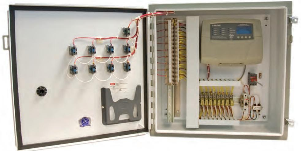
El secuenciador de rendimiento adaptado de Marley, disponible en los sistemas de 8 o 16 etapas, estratificarán las celdas de múltiples ventiladores de una torre de enfriamiento a partir de una única ubicación de medición de temperatura sobre la base de un único punto de ajuste de temperatura. Ya no son necesarios los termostatos mecánicos antiguos con puntos de ajuste estratificados en cada celda del ventilador de la torre de enfriamiento.
