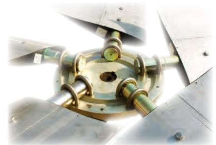
Además, todas las aspas se equilibran para que sus pesos coincidan con el momento dinámico, lo que permite intercambiar todas las aspas del X7 sin necesidad de volver a equilibrar todo el conjunto del ventilador.
