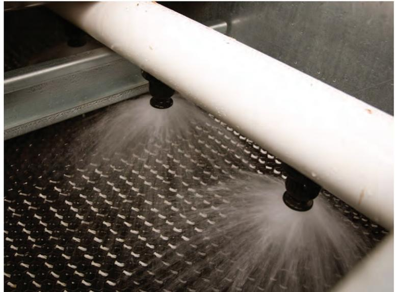
La tobera de contraflujo NS7 de Marley es una unidad de polipropileno moldeado a inyección que consta de dos partes: el conjunto principal con un turbulador integral y un pasatubos de goma EDPM. Las toberas NS7 se diseñaron para proporcionar de forma económica el rendimiento térmico deseado a bajas alturas de atomización típicas de las torres de enfriamiento ensambladas en fábrica.
