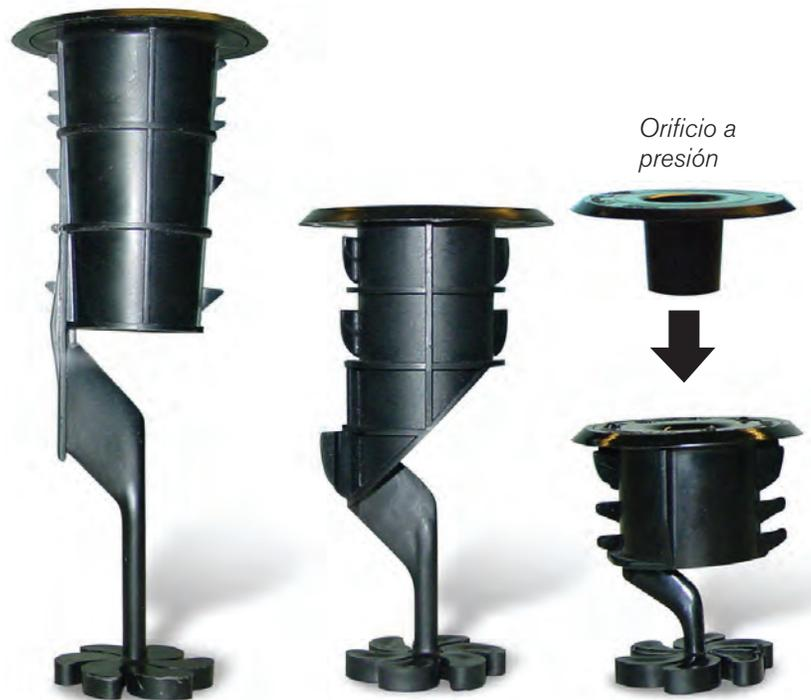
La tobera SpiralTarget de Marley es una unidad de polipropileno moldeado a inyección que consta de dos partes: el cuerpo principal con un difusor objetivo integral y una pieza a presión o una tapa de orificio.
