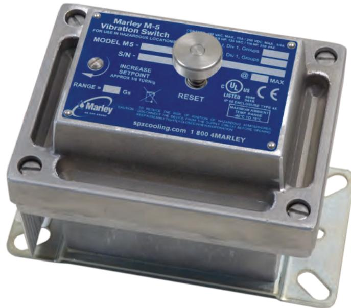
El interruptor de vibraciones M-5 de Marley se diseñó para cumplir con todos los requisitos para los interruptores mecánicos en un único paquete económico. Esta unidad proporciona una protección contra la vibración económica para el equipo mecánico de la torre de enfriamiento. Un mecanismo sensible a la inercia activa un interruptor de cierre automático con contactos de salida SPDT si la vibración supera el punto de ajuste configurable.
