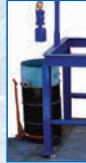
Sistema de decantación con cubierta de tambor (SDS)
